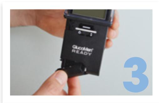
Öffnen Sie das Kartuschenfach, indem Sie es nach links schieben und dann nach unten öffnen.
