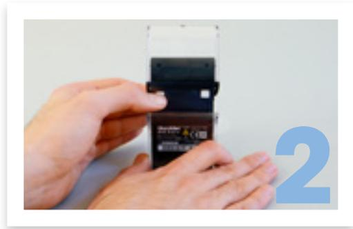
Belassen Sie den GlucoMen® READY auf dem festen Untergrund, drehen ihn um und schieben Sie die obere Abdeckung nach oben. Schieben Sie dann den linken Hebel (weißer Knopf, Pfeil zeigt auf unteres Cover) bis zum Anschlag nach unten (leichtes Klicken ist zu hören) und ziehen den GlucoMen® READY aus dem Cover heraus.
