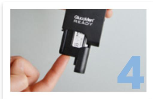
Legen Sie die neue Kartusche in Pfeilrichtung ein und schließen Sie das Kartuschenfach wieder.
